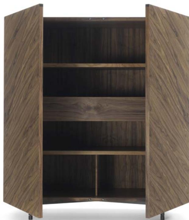
Credenza in legno multistrato, caratterizzata da ante a battente con particolare disegno a spina di pesce e maniglia fresata. Dotata di mensole interne e cassetto in massello assemblato con incastri a coda di rondine. Finitura: a base di olio/cera naturale di origine vegetale con estratti di pino.
