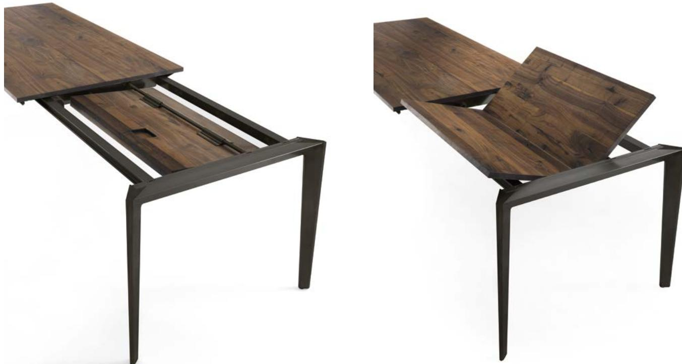
Sistema di prolunghe integrato nel top. La prolunga a scorrimento si estrae da uno dei lati corti del top, grazie a ruote in teflon poste sotto le gambe del tavolo e ai due binari telescopici in alluminio che si muovono su sfere metalliche. Il sistema è dotato di apertura "a libro" e sfrutta il peso e il contrappeso della prolunga stessa.
